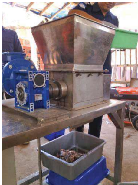
Gambar 7. Pencacahan dengan shredder (uji lapang)
